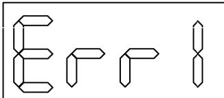
Chyba snímaču 1 až 4 (prerušený kábel, a podobne)
